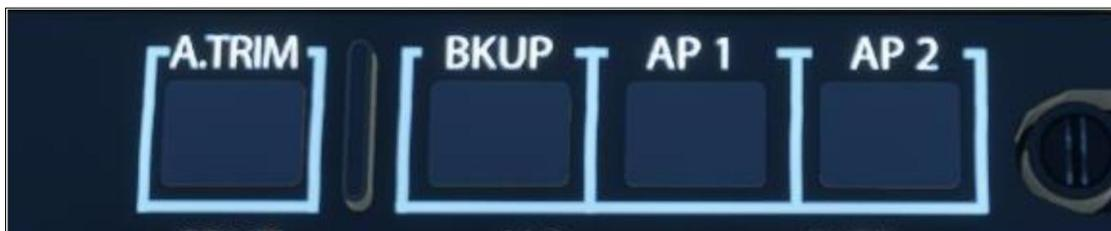
Wenn Sie die Warnung AFCS DISENGAGED auf der primären Fluganzeige sehen, sollten Sie die obige Konfiguration überprüfen.
