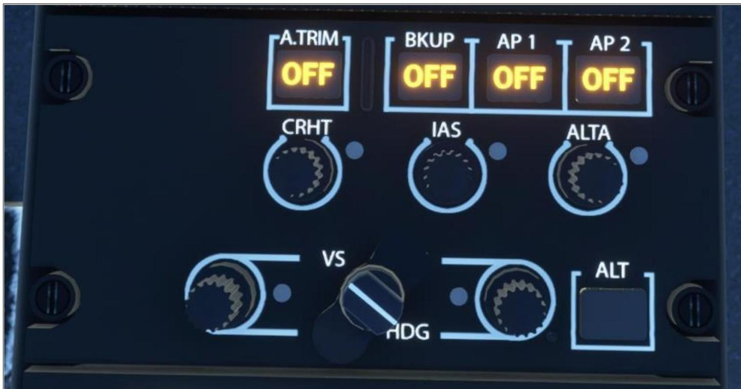
Jedes gelbe **OFF** muss durch Drücken gelöscht werden. Wenn die Taste leer ist, bedeutet dies, dass das System eingeschaltet ist.
